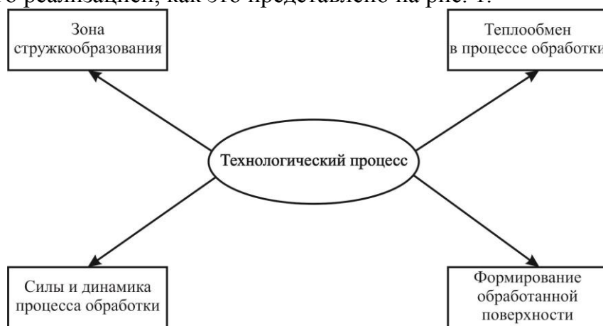
Рис. 1. Области моделирования технологического процесса обработки резанием
