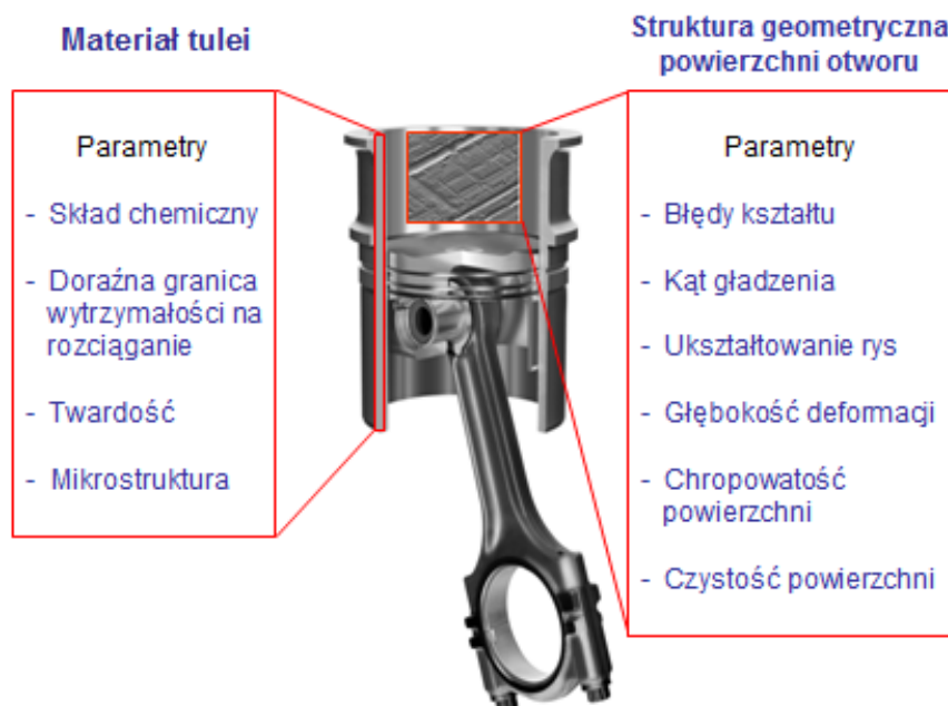
Rys.6. Cechy funkcjonalne tulei cylindrowej
