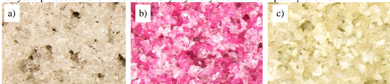
Rys. 7. Struktura ściernic: a) elektrokorund szlachetny, b) mieszanka elektrokorundu różowego, c) mieszanka korundu spiekane.
