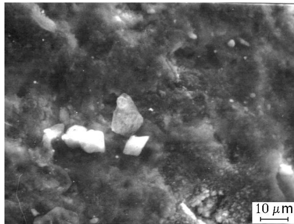
Rys. 22 a, b. SEM powierzchni PCD po WEDM (dla: U = 80V , I = 8A , t_i = 1,2 \mu s , t_o = 5,8 \mu s , V_f = 1,4 \text{ mm/min} )
