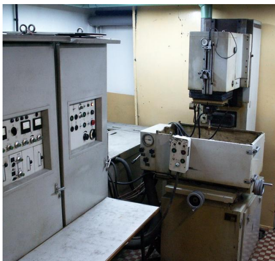
Rys. 27. Drażarka elektroerozyjna EDEA-25 a), schemat drążenia swobodnego b)[22]
