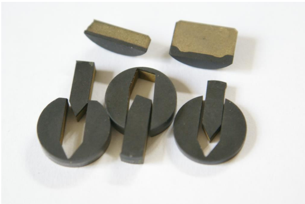
Rys. 13. Mikronarzędzia wycięte WEDM z półfabrykatów (krążków) PCD [23]
