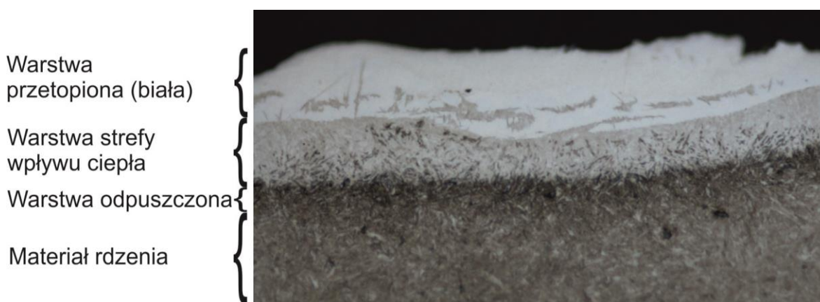
Rys. 10. Mikrostruktura powierzchni po obróbce elektroerozyjnej
