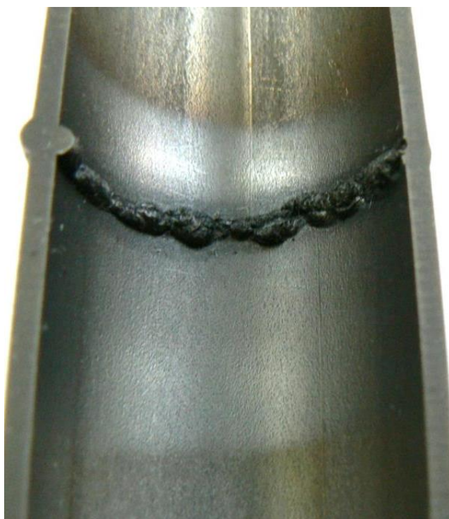
Rys. 10. Widok złącza spawanego z wyraźnym śladem obróbkowym
