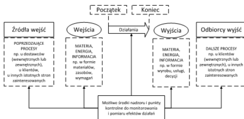
Rys. 3.1. Schematyczne przedstawienie procesu i jego elementów (PN EN ISO 9001:2015) [96]
