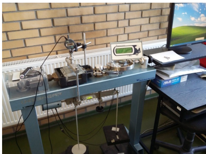
Fot. 2. Stanowisko do oznaczania wytrzymałości w aparacie bezpośredniego ścinania
