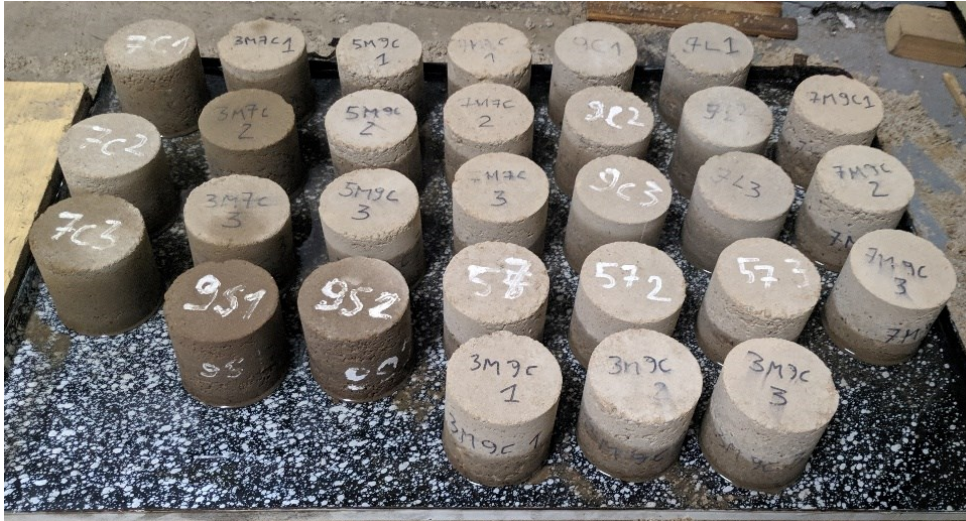
Fot. 7. Badanie kapilarności mieszanki gliny piaszczystej – widok po 24 h od zanurzenia
