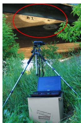
Rys. 10. Most Chrobrego (Poznań) – termografia pasywna wykorzystująca naturalne zmiany dobowe temperatury (widok stanowiska, przykład termogramu spodu ustroju nośnego przęsła skrajnego)
