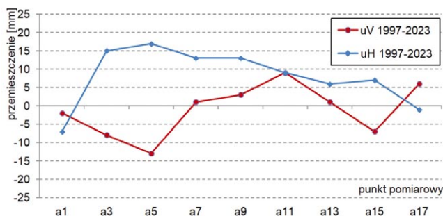
Rys. 7. Przeszaczenia pionowe ( u_V ) i poziome poprzeczne ( u_H ) cięćna nośnego po stronie górnej wody w okresie 1997–2023
