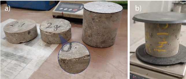
Rys. 1. Rdzeń wiercony Ø100x100 mm: a) odcięte fragmenty skrajne oraz powiększenie obszaru przejściowego powierzchni zacieranej mechanicznie, b) próbka po nałożeniu mieszaniny siarkowej
