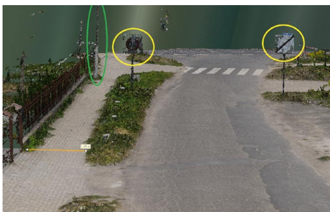
Rys. 5. Przykład możliwości wykorzystania chmury punktów do inwentaryzacji obiektów w pasie drogowym (opracowanie własne)
