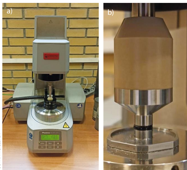
Rys. 1. Reometr DSR typu Physica MCR 101: a) widok ogólny reometru, b) próbka asfaltu przy użyciu wrzeciona Ø8 mm
