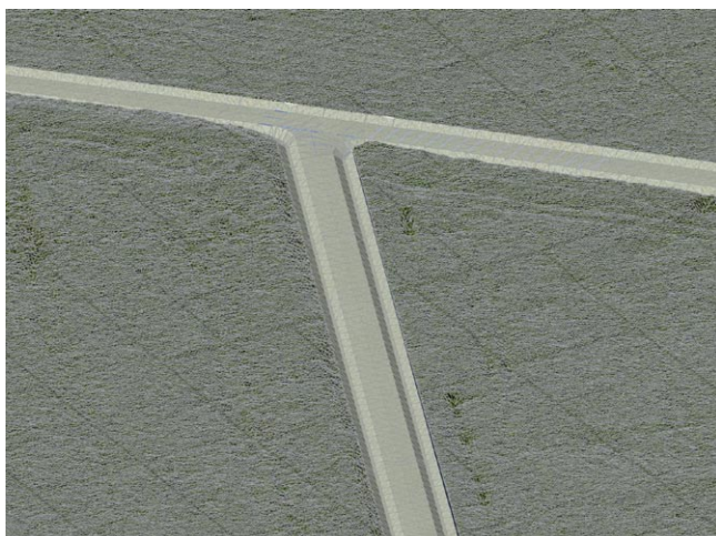
Rys. 1. Przykład wykorzystania NMT (TIN) przy projektowaniu skrzyżowania dróg w środowisku CAD (opracowanie własne)
