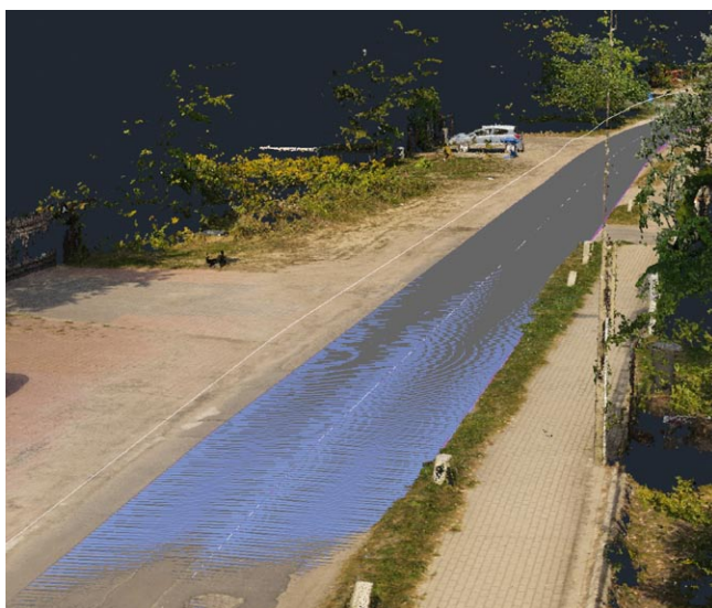
Rys. 2. Przykład wykorzystania chmury punktów przy projektowaniu przebudowy drogi w środowisku CAD (opracowanie własne)
